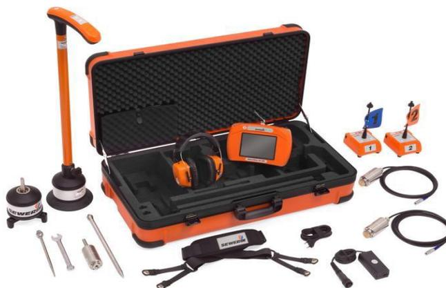
2.11 Los micrófonos piezoeléctricos de alta calidad, con una respuesta de frecuencia optimizada para la detección de fugas, así como el procesamiento digital de señal garantizan el logro de propiedades
