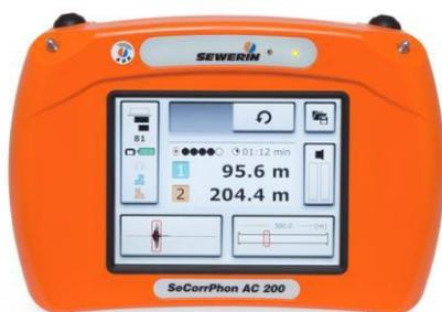
2.15 En la función localización acústica de fugas, la estructurada pantalla de 5,7 pulgadas del receptor muestra la intensidad actual del sonido de forma gráfica y como valor numérico. Asimismo, puede ver los valores anteriores para realizar la comparación con más facilidad, así como mostrar el análisis de frecuencia actual del ruido.
